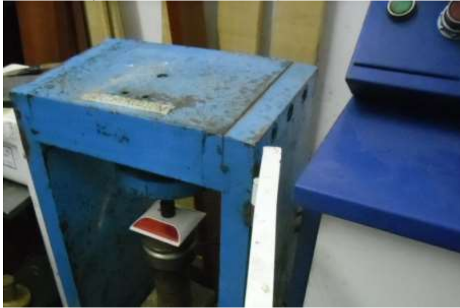
Gráfico 8. Ensayo de resistencia a la compresión a tachas reflectivas
