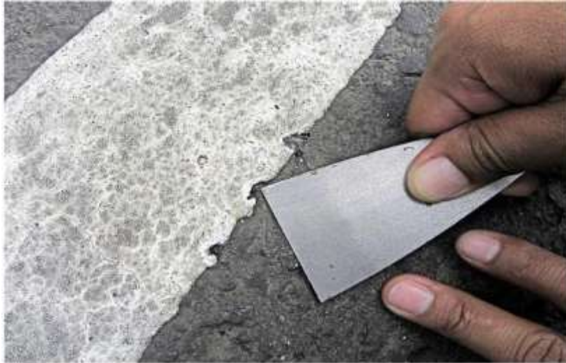
Gráfico 28. Prueba de adherencia de la resina termoplástica
