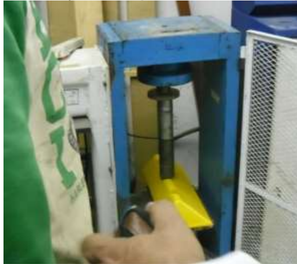
Gráfico 11. Ensayo de compresión a bordillo traspasable.
