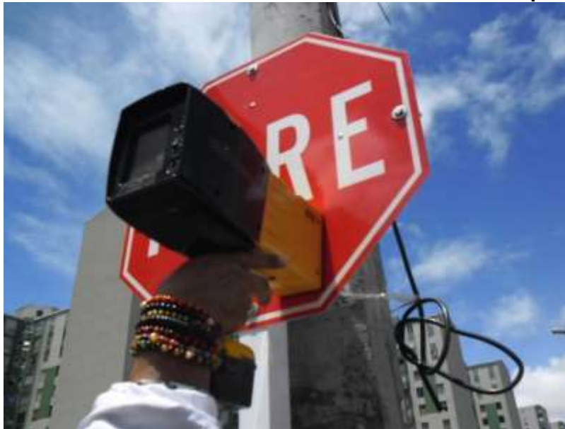
Gráfico 2. Toma de retrorreflexión a señal vertical de pedestal
