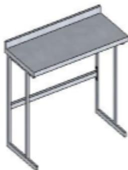
Mesa en acero inoxidable 304 calibre 18, con omegas de reguerzo en acero inoxidable 304 calibre 18. Estructura en tubo cuadrado de 1.5" calibre 18.
