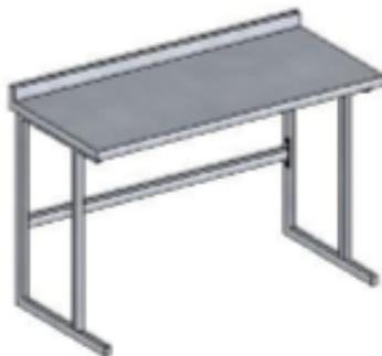
Mesa en acero inoxidable 304 calibre 18, con omegas de reguerzo en acero inoxidable 304 calibre 18. Estructura en tubo cuadrado de 1.5" calibre 18.
