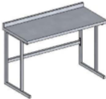
Mesa en acero inoxidable 304 calibre 18, con omegas de refuerzo en acero inoxidable 304 calibre 18. Estructura en tubo cuadrado de 1.5" calibre 18.
